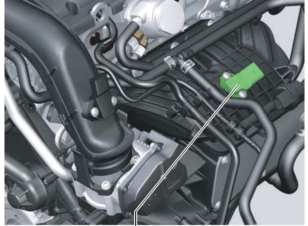
Transmetteur de pression de tubulure d'admission G71 avec transmetteur de température de l'air d'admission G42 S405_044
