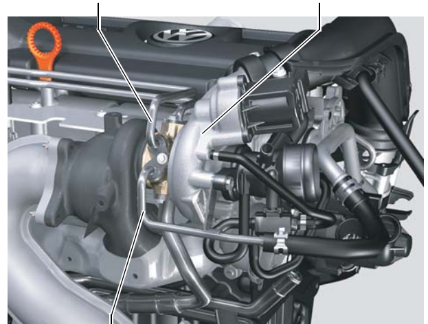
Amenée du liquide de refroidissement
