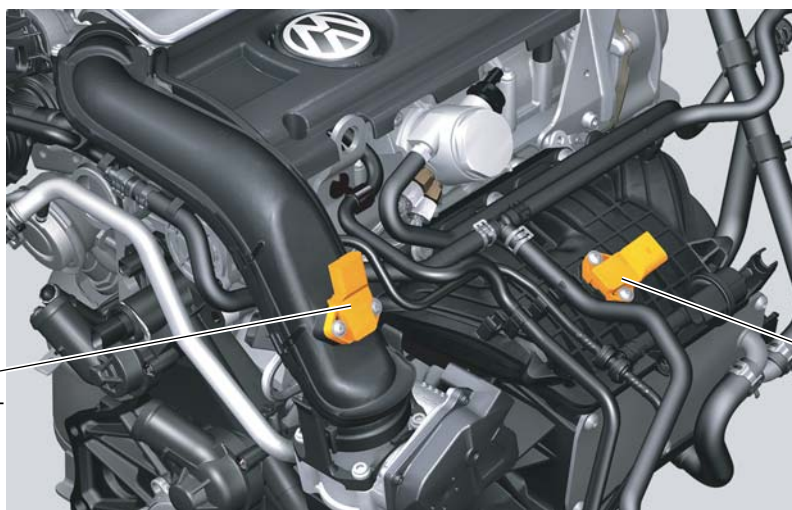
Transmetteur de pression de suralimentation G31 avec transmetteur -2- de température d'air d'admission G299
