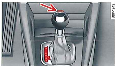
Fig. 115 Vue partielle de la console centrale : levier sélecteur avec touche de blocage
