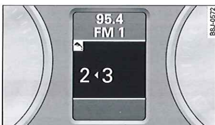
Fig. 17 Combiné d'instruments : indicateur de changement de rapport (programme d'efficacité)
