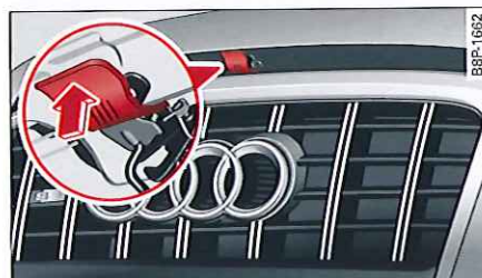
Fig. 171 Bouton à bascule sous le capot-moteur
