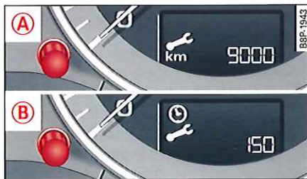
Fig. 6 Combiné d'instruments : indicateur de périodicité d'entretien (A : kilomètres / B : jours)
