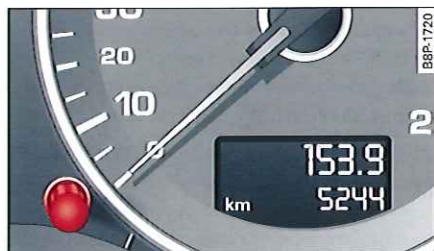
Fig. 5 Combiné d'instruments : compteur kilométrique avec bouton de remise à zéro
