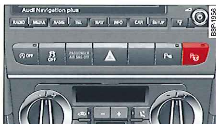
Fig. 104 Console centrale : touche de l'assistant aux manœuvres de stationnement
