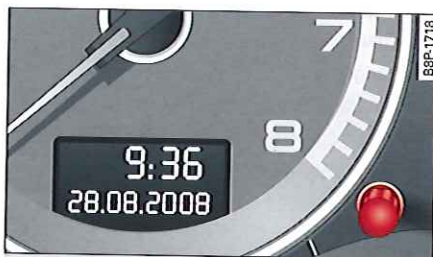
Fig. 4 Combiné d'instruments : bouton de réglage/contrôle
