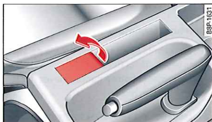
Fig. 66 Prise de courant sur la console centrale
