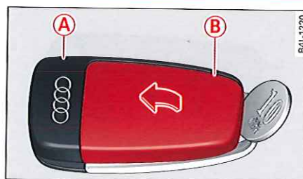
Fig. 24 Clé à radiocommande : retrait du cache
