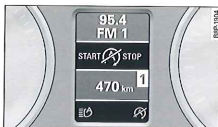
Fig. 111 Combiné d'instruments avec ordinateur de bord : fonction « arrêt du moteur » temporairement non disponible
