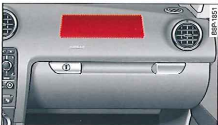
Fig. 143 Airbag passager avant intégré au tableau de bord
