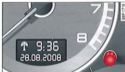
Fig. 8 Combiné d'instruments : zone d'affichage du symbole de réception de l'horloge radiopilotée, de l'heure et de la date.
