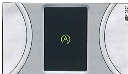
Fig. 109 Combiné d'instrument sans ordinateur de bord : moteur coupé (phase stop)
