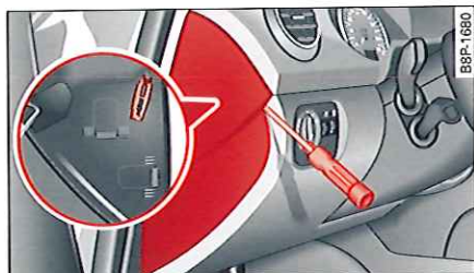
Fig. 207 Côté gauche du tableau de bord : couvercle des fusibles
