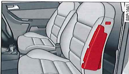
Fig. 146 Emplacement de montage de l'airbag latéral dans le siège conducteur
