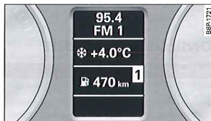
Fig. 9 Système d'information du conducteur au combiné d'instruments
