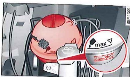
Fig. 176 Compartiment-moteur : repères sur le vase d'expansion de liquide de refroidissement
