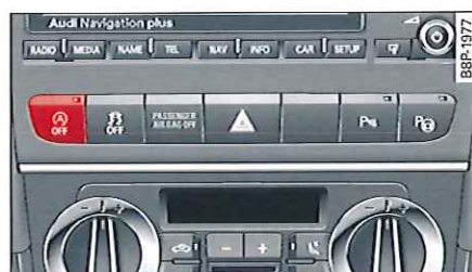
Fig. 112 Console centrale : touche du système start/stop
