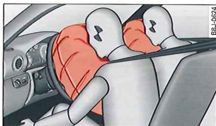
Fig. 144 Airbags frontaux déployés
