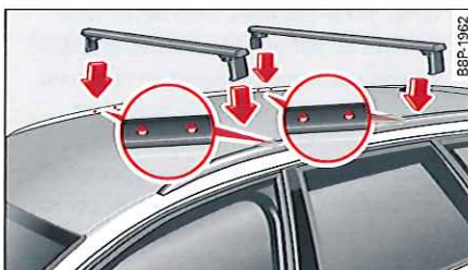
Fig. 73 Avec barres de toit* : points de fixation pour la galerie porte-bagages
