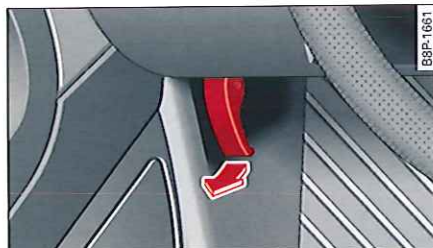
Fig. 170 Vue partielle du plancher côté conducteur : levier de déverrouillage
