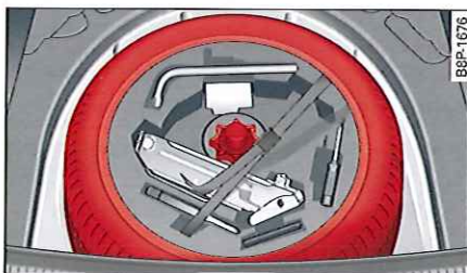
Fig. 191 Roue d'urgence dans le cuvelage de la roue de secours
