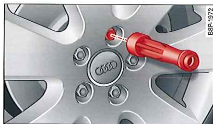
Fig. 197 Changement de roue : six pans creux pour le serrage des boulons
