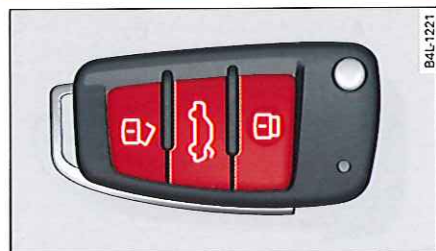
Fig. 25 Clé à radiocommande : affectation des touches
