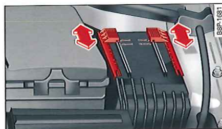
Fig. 208 Compartiment-moteur, côté gauche : couvercle de fusibles
