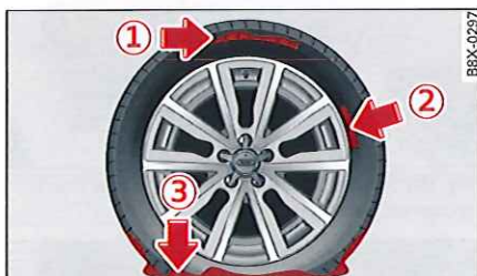
Fig. 200 Dommages pour lesquels le kit anticrevaison ne convient pas
