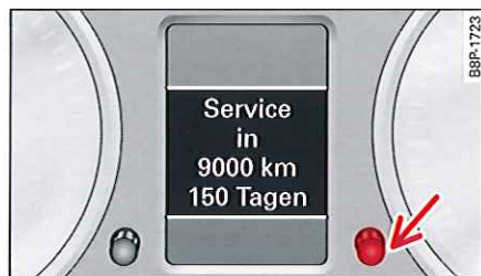
Fig. 20 Combiné d'instruments : indicateur de périodicité d'entretien
