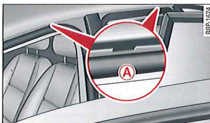
Fig. 72 Sans barres de toit : points de fixation des supports
