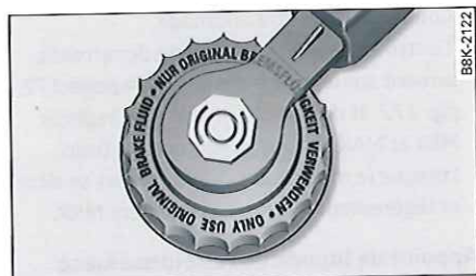
Fig. 177 Compartiment-moteur : repères du réservoir de liquide de frein
