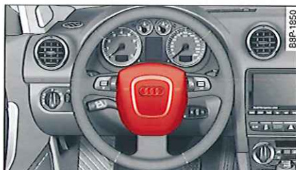
Fig. 142 Airbag conducteur intégré au volant de direction
