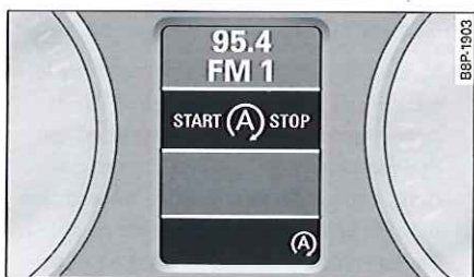
Fig. 110 Combiné d'instrument avec ordinateur de bord : moteur coupé (phase stop)
