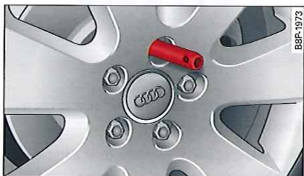
Fig. 198 Changement de roue : axe de montage dans l'orifice supérieur
