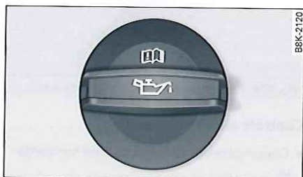
Fig. 175 Compartiment-moteur : bouchon de l'orifice de remplissage d'huile-moteur
