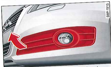
Fig. 227 Partie avant gauche : extraction du cache
