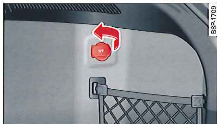
Fig. 67 Revêtement latéral du coffre à bagages : prise de courant de 12 volts
