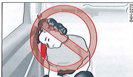
Fig. 125 Représentation schématique d'une position assise dangereuse dans la zone de déploiement de l'airbag latéral.
