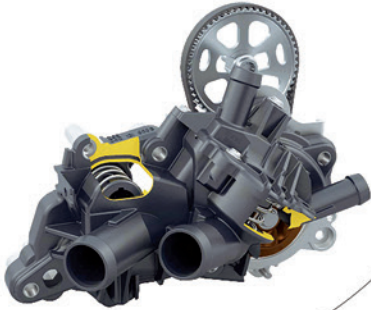
Pompe de liquide de refroidissement intégrée au boîtier du thermostat
