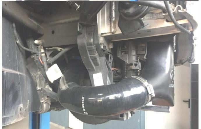
**WAGNERTUNING** Ladeluftkühler**Hinweise für Fahrzeuge mit zusätzlicher Kühlschleife für die Dynamiklenkung.**
