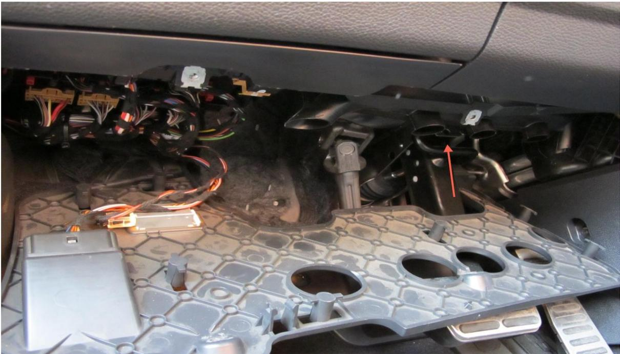
Una vez retirada la tapa inferior, tendremos que localizar la conexión del Gateway para “puentearla” con el PolarFIS (ver mas adelante)
